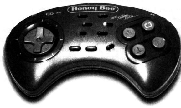
Na pravé straně ovladače se nachází čtyři barevné odlišená tlačítka pro střelbu. Jejich funkce je naprosto bezchybná. Červené tlačítko má funkci klasické střelby, naprosto identickou jako obyčejný jednotlačítkový joystick. Tlačítka modré má funkci druhé střelby, kterou mají i některé lepší páky. Tlačítka zelené a žluté mají speciální využití u přehrávače CD disků a u některých dalších her, které je využívají (Super Street Fighter II.).
